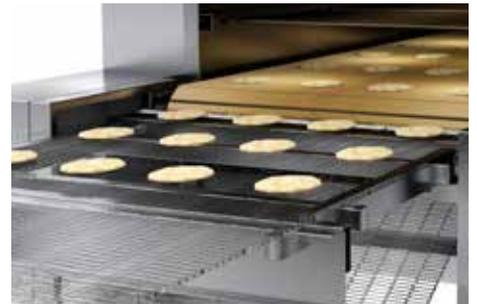
Carril de transporte de entrada y salida que contribuye a un mejor flujo del proceso en la producción. Ensamble el horno con otras máquinas en la línea de producción como, por ejemplo, un carril de moldeo o una estación de envasado posterior.
