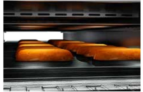
Cinta de acero perforada para hornear pan suelto más alto con mucho volumen, como las hogazas de pan.
