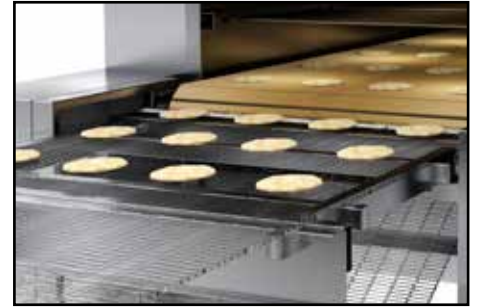
Förderband an der Beschickung und an der Ausgabe, das zu einem besseren Prozessfluss in der Produktion beiträgt. Setzen Sie den Ofen mit den anderen Maschinen in der Produktionslinie zusammen, wie z. B. Formband oder nachfolgende Verpackungsstation.
