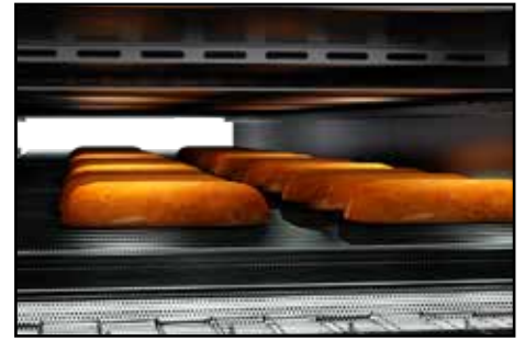
Perforiertes Stahlband zum Backen von freigeschobenen, höheren Broten mit großem Volumen wie z. B. Laiben.
