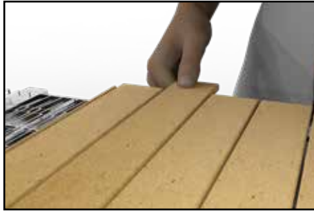
Geteiltes Steinband, bei dem einzelne Steine bei Bedarf einfach stückweise ersetzt werden. Die Halterung des Steins wird gelöst und die einzelnen Steinplatten werden einfach zur Seite hin herausgezogen.
