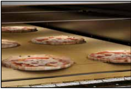
Steinplattenband für das Backen von Pizza, libanesischem Brot, Pitabrot, Naan-Brot usw.
