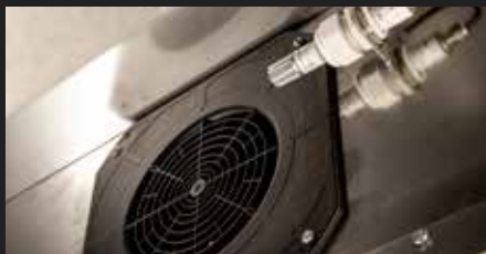
Los ventiladores funcionan a demanda para ahorrar energía y proporcionan el clima de fermentación perfecto.
